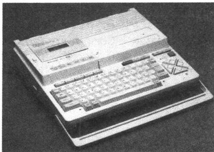
Hier sehen sie z.B. den Mirwald MSX mit eingebautem Cassetten Recorder. Die Tastatur ist in der Art der IBM Tastatur gehalten. Eine Supergrafik, ähnlich dem Apple Macintosh ist eingebaut. Mit dem Joystick lassen sich über Ikonen und Symbole Grafiken erstellen und mit Text mischen. Ein Zoom erlaubt ein Verändern der Zeichen usw. Weiterhin ist ein Musiksynthisizer und ein Maschinensprachen Monitor in ROM enthalten.
