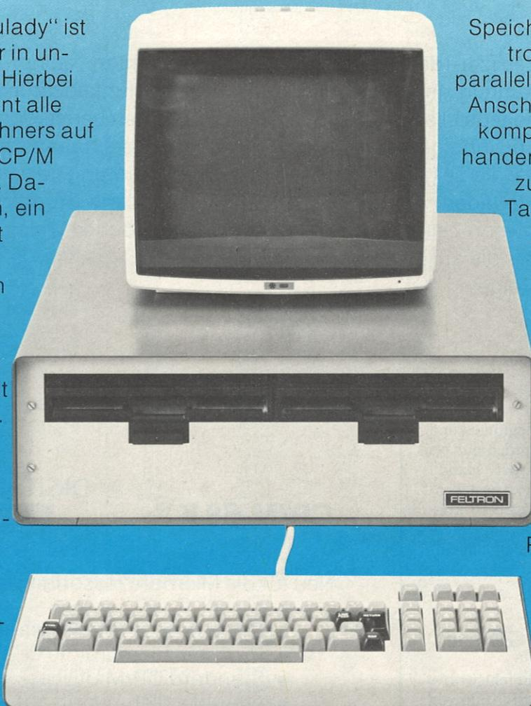
Speicher und ein CRT-Controller. Weiterhin ist eine parallele Schnittstelle für den Anschluß eines Centronics-kompatiblen Druckers vorhanden. Außerdem gehören zum Lieferumfang eine Tastatur (mit separatem Zehnerfeld) sowie ein Datenmonitor.
