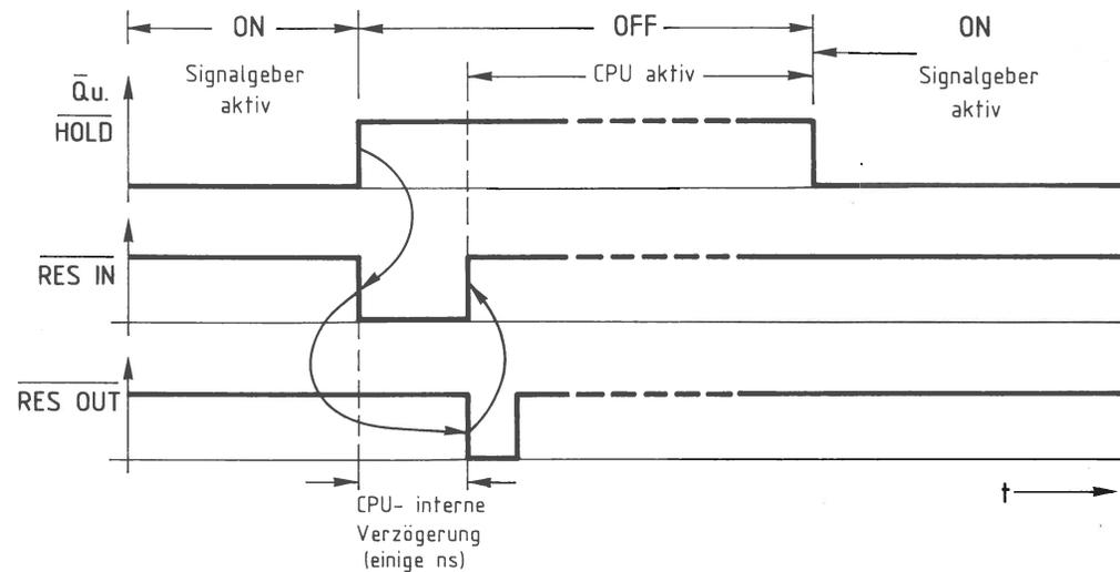
Bild 8: Das Impulsdigramm der Reset-Steuerung.
