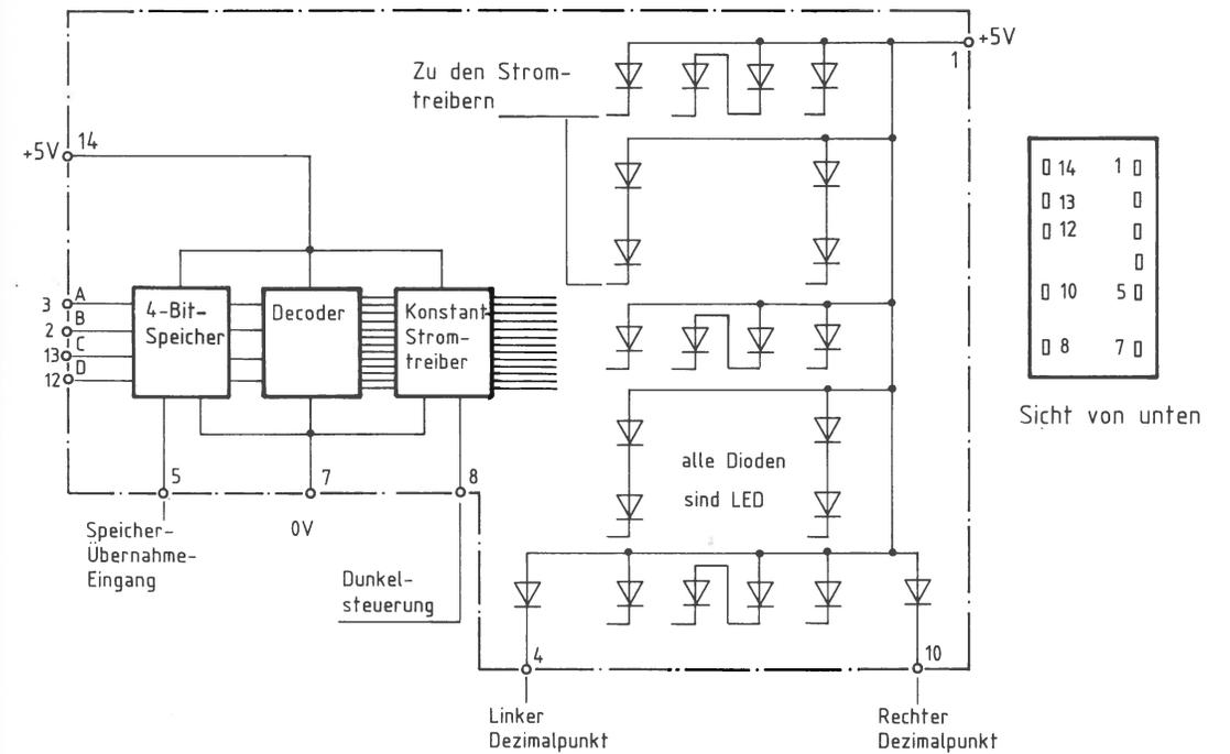
Bild 11: Blockaufbau und Pin-Belegung der Hexadezimal-Anzeige TIL 311.
