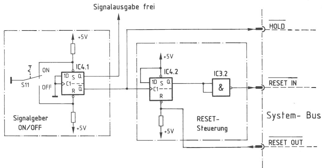
Bild 7: Die Reset-Steuerung und die Umschaltung »Signalgeber ON/OFF«
