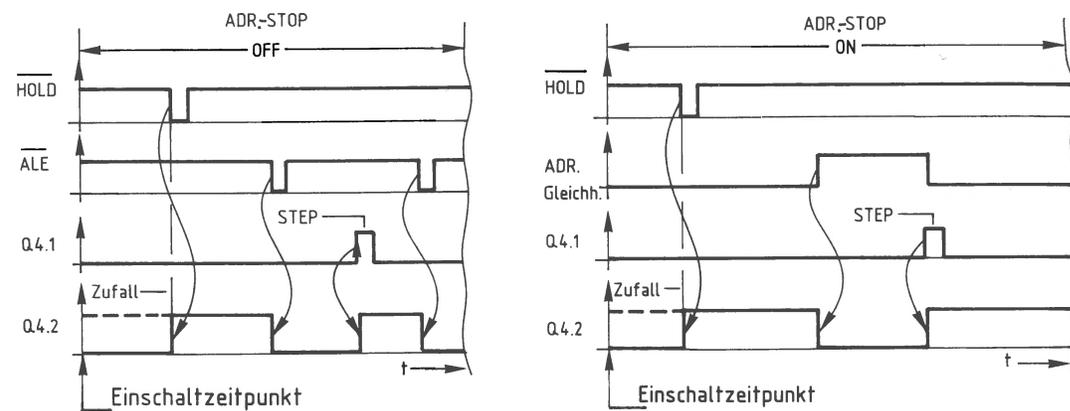
Bild 16: Liniendiagramm der Signale  $\overline{HOLD}$ ,  $\overline{ALE}$ , ADR-Gleichheit, Q4.1 und Q4.2.
