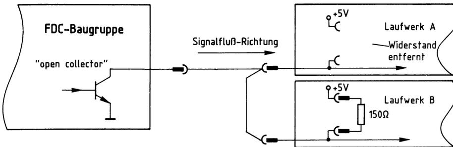
Bild 144: Der Anschluß der Laufwerk-Steuersignale, hier nur für eine Leitung gezeigt.
