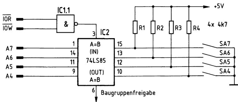
Bild 153: Die Schaltung des Adreßvergleichers.
