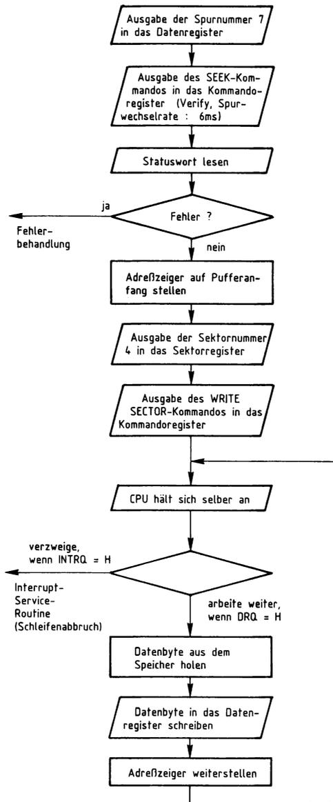
Bild 180: Schreiben des Sektors 4, Spur 7, Synchronisation über die Signale DRQ und INTRQ.
