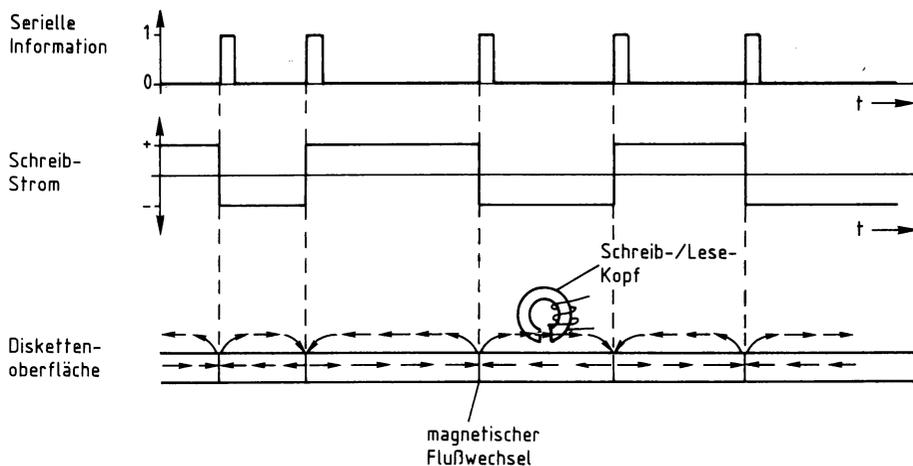
Bild 139: Die magnetischen Flußwechsel innerhalb der Disketten-Oberfläche.
