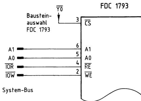
Bild 164: Der Anschluß des FDC-Bausteins 1793 zur Register-Auswahl.
