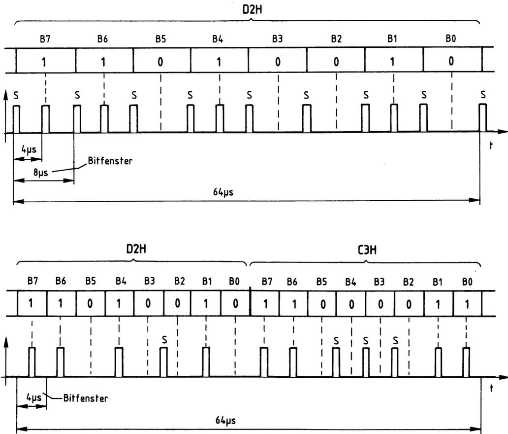
Bild 186: Vergleich der Aufzeichnungs-Verfahren FM und MFM.
