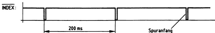
Bild 148: Das Rückmeldesignal  $\overline{\text{INDEX}}$  zur Erkennung des Spuranfangs.
