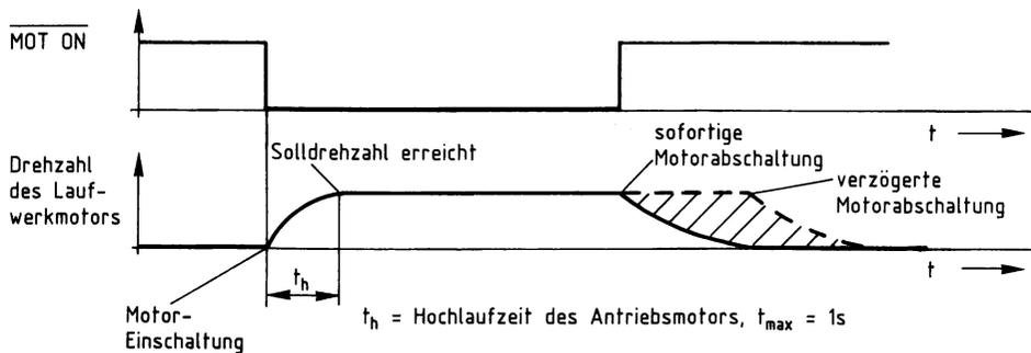
Bild 147: Die Ein- und Ausschaltung der Laufwerkmotoren.
