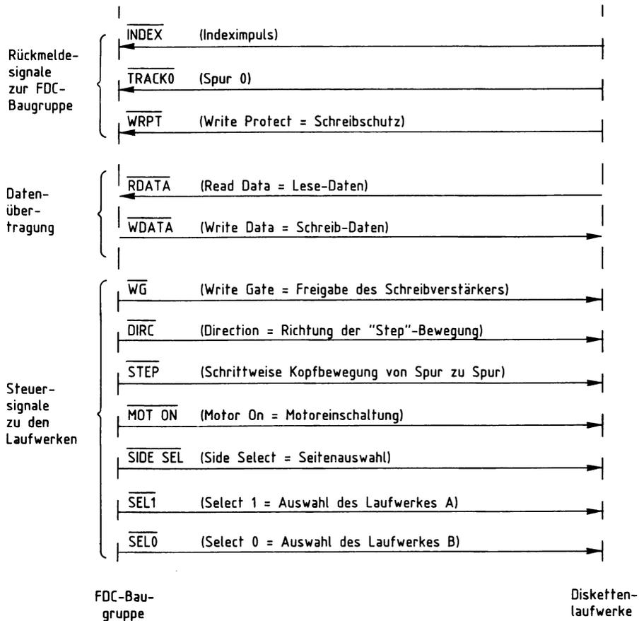
Bild 143: Die Signalleitungen zwischen FDC-Baugruppe und Diskettenlaufwerken.
