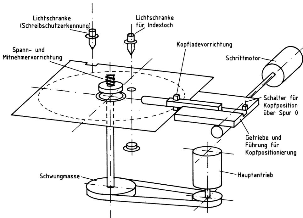
Bild 140: Ein Beispiel für die Teile eines Disketten-Laufwerkes.
