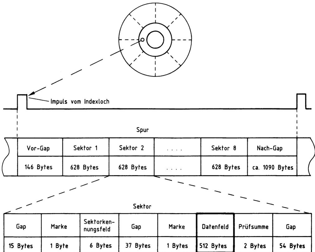
Bild 184: Das Format einer Diskettenspur beim MFA-Mikrocomputer.
