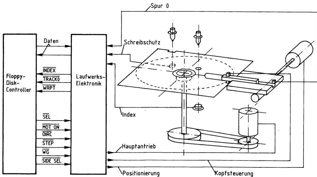
Bild 142: Die Zusammenschaltung von Floppy-Disk-Controller und Laufwerk.
