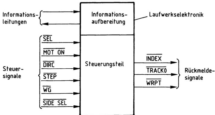
Bild 141: Die Steuer- und Rückmelde-Signale der Laufwerks-Elektronik.
