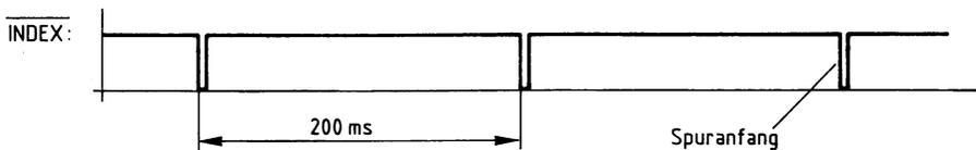
Bild 171: Das Rückmeldesignal  $\overline{\text{INDEX}}$  zur Erkennung des Spuranfangs.
