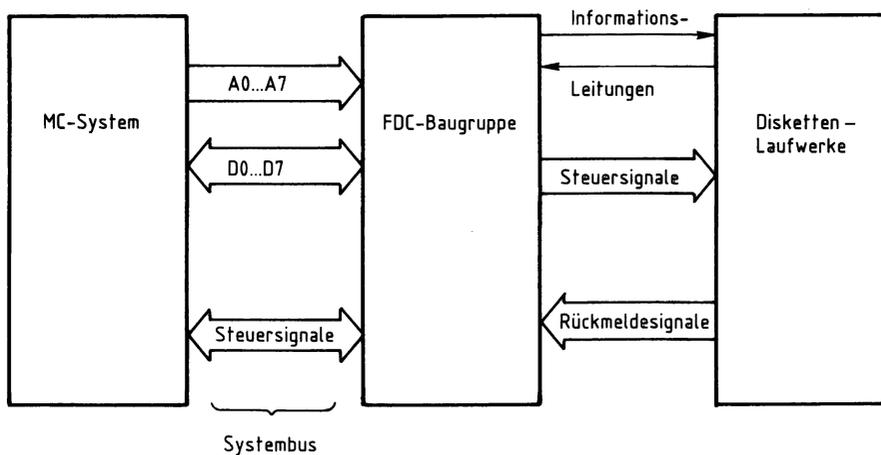
Bild 150: Die Zusammenschaltung von Mikrocomputer, Floppy-Disk-Controller und Laufwerken.
