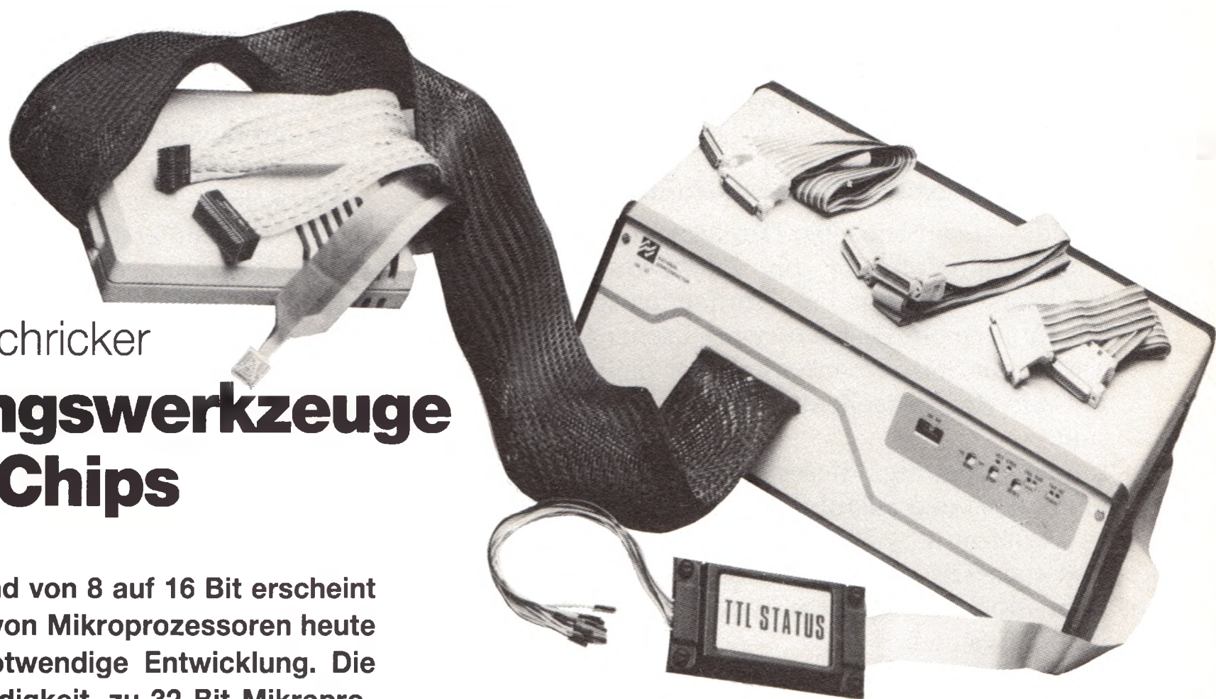
Der Emulator ISE 32 wird samt Cross-Software für die Serie 32000 von National Semiconductor angeboten. Er erlaubt 10-MHz-„Echtzeit“-Betrieb
