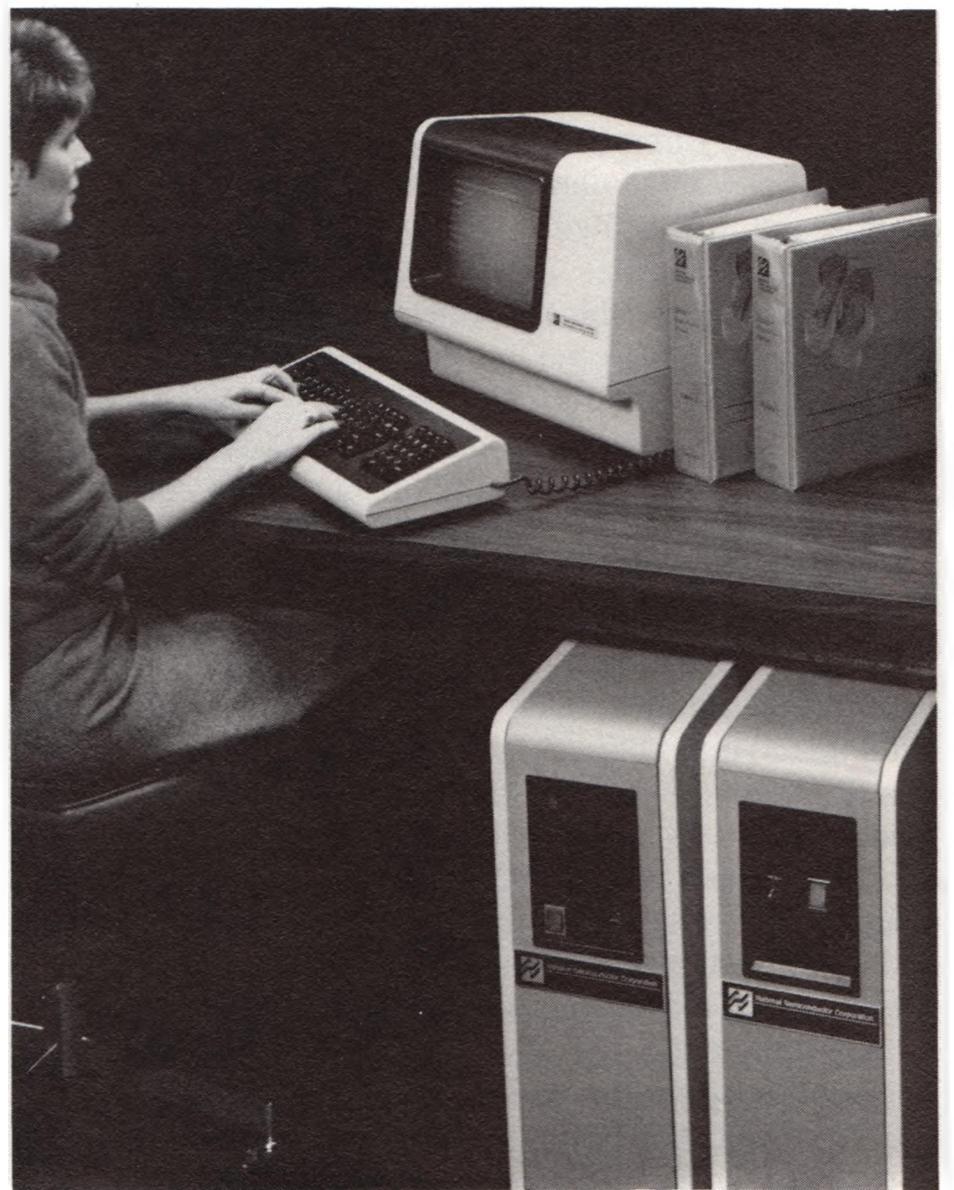
Bild 1. Das Entwicklungssystem SYS 32 unterstützt die Verwendung von Hochsprachen und modulare Programmierung
