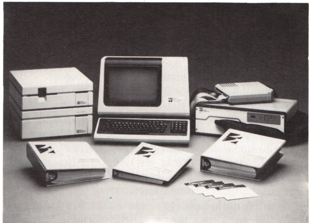
Bild 2. VR32 ist ein vollständiges Entwicklungssystem für die Prozessoren der 32000-Familie mit Emulator
