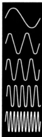
Netzfrequenz von 50 Hz) in geeigneter Amplitude auf den Y-Eingang zu schalten, und stellt die Kippfrequenz so ein, daß sich stehende Kurvenbilder ergeben. Bild 6 zeigt einige solcher Oszillogramme, aus denen sich aus der zugeführten bekannten Normalfrequenz  $f_n$  und den auf dem Schirm entstehenden vollen Perioden  $N_{fn}$  die eingestellte Kippfrequenz  $f_k$  berechnen läßt. Es gilt die Formel
