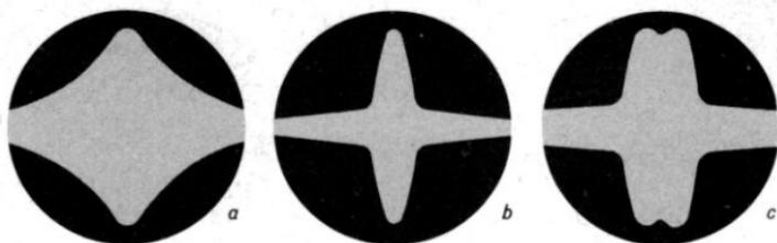
Bild 61. Bandfilterkurven a) unterkritische Kopplung, b) kritische Kopplung, c) überkritische Kopplung
