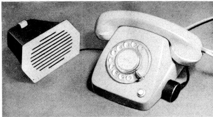
Bild 384. Ansicht des betriebsfertigen Telefonverstärkers
