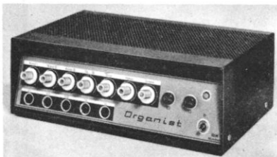
Bild 249. Ansicht des betriebsfertigen Verstärkers
