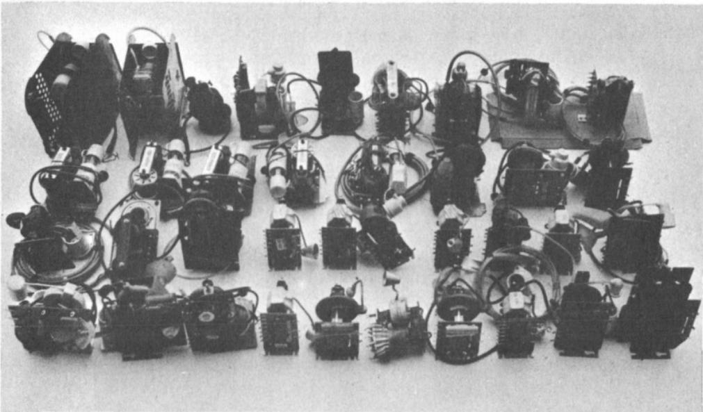
Bild 12.01-1. Eine kleine Auswahl verschiedener Zeilentransformatortypen
