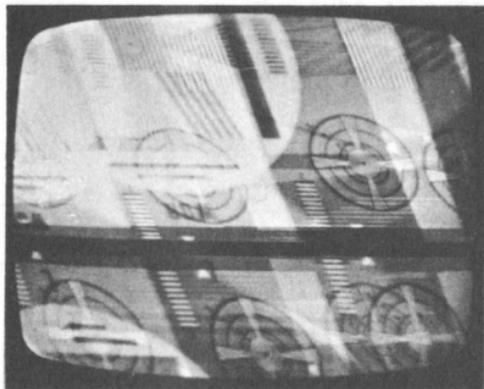
*Bild 9.02-1. Typisches Schirmbild bei einem Amplitudensiebfehler*
