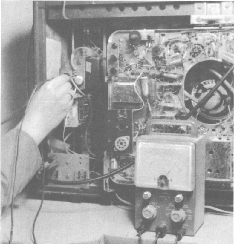
*Bild 3.05–1. Kontrolle des VHF-Oszillators durch Spannungsmessung*
