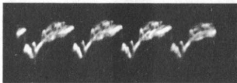
Ein hin und wieder auftretender Fehler, der zwar am Oszillogramm am Steuergitter der Videoendstufe leicht zu erkennen ist (**Bild 8.05–1**), dessen Ursache aber manchmal nicht leicht festzustellen ist, liegt vor, wenn der Siebkondensator der getasteten Regelung (C 2 in Bild 8.01–2) seinen Wert verkleinert hat oder wenn er eine Unterbrechung aufweist. Das Schirmbild kann dann
