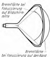
Bild 3. Der Kolben einer Fernseh-Bildröhre mit zwei eingetragenen Brennflächen . Das sind Flächen, auf denen der Brennpunkt des abgelenkten Elektronenstrahls liegt. Im einen Fall ist auf die Bildschirmitte, im andern Fall auf den Bildschirrand fokussiert. Wie man sieht, sind die Brennflächen stark gewölbt, weit stärker als die Bildröhren-Frontplatte.
