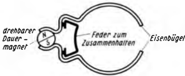
Bild 47. Zentriermagnet, bestehend aus einem drehbar angeordneten Dauermagnetzylinder und zwei Weicheisenklammern, die mittels einer Feder zusammengehalten sind
