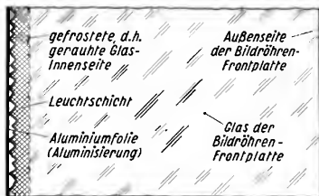
Bild 14. Schnitt durch ein kleines Stück der Bildröhren-Frontplatte. Hinter der dicken Glasschicht befindet sich auf der gerauhten Glasinnenseite die Leuchtschicht. Über deren unebener Oberfläche liegt die glatte Aluminiumfolie.
