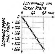
Bild 25. Graphische Darstellung des Spannungsverlaufes längs der Verbindungslinie zwischen den Mitten zweier ebener, einander parallel in einem Abstand von 0,8 mm gegenüberstehender Platten. Die rechte Platte hat gegen die linke eine Gleichspannung von + 600 V. Abhängig von der Entfernung ab Mitte der linken Platte ist die Spannung gegen diese Platte in Ordinatenrichtung aufgetragen. Jede Spannungsdifferenz kann man als Höhenunterschied auffassen.
