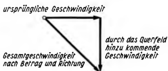
Bild 31. Wie sich die Geschwindigkeiten zusammensetzen, die durch die Beschleunigungen im Längs- und Querfeld erzielt werden. Hier ist angenommen, daß die ursprüngliche und die durch das Querfeld hinzukommende Geschwindigkeit gleich groß sind. Die Richtung der Gesamtgeschwindigkeit weicht demgemäß von der Richtung der ursprünglichen Geschwindigkeit um 45^\circ ab.
