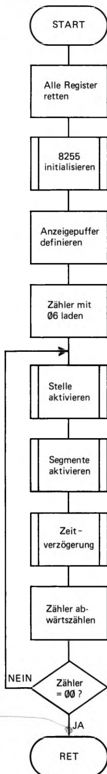
Bild S78.1 Der Programmablaufplan zur Ansteuerung der Anzeige. Programmstart ist die Adresse 1800H.
