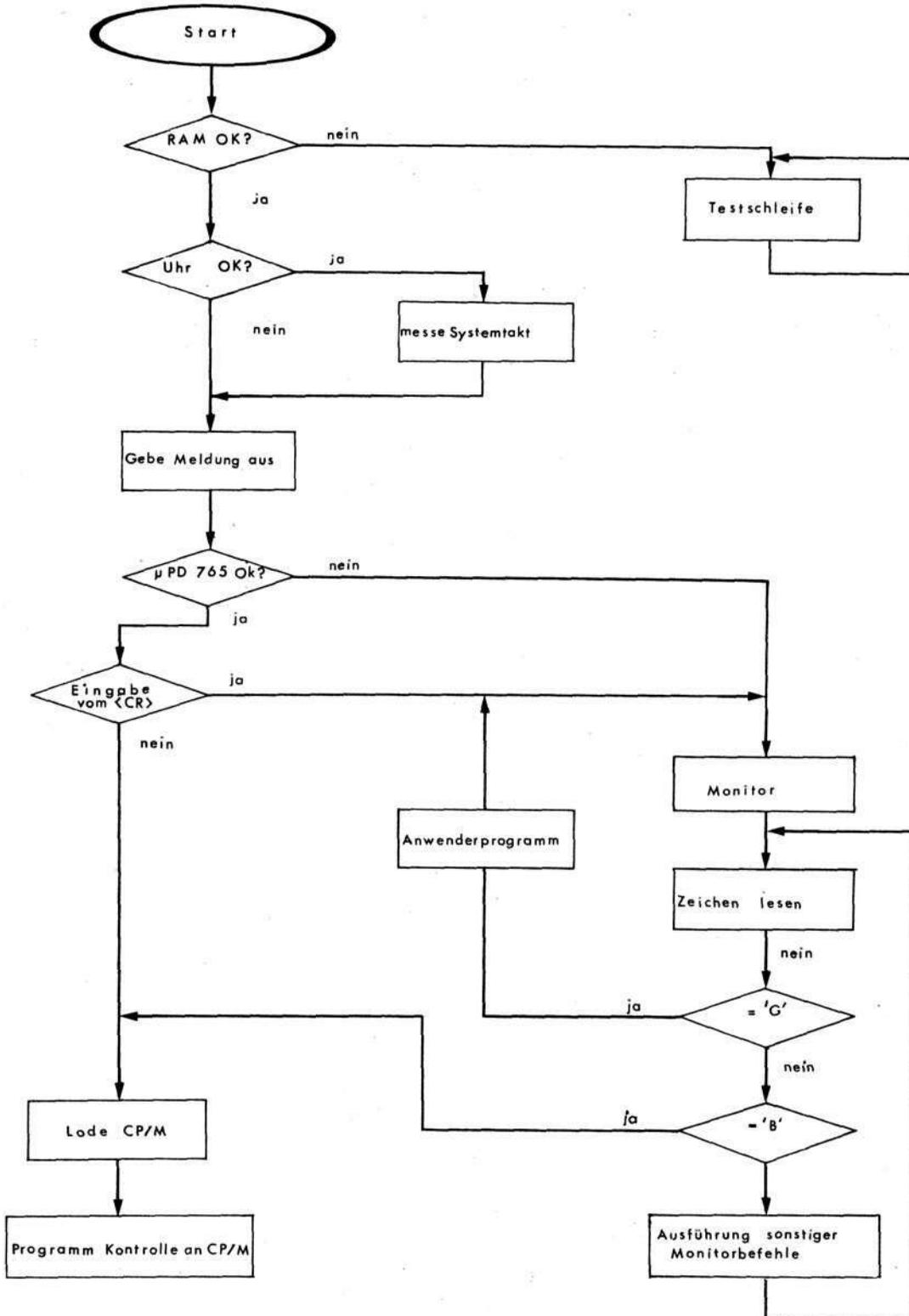
Nach dem Testen der RAM's wird geprüft, ob die Echtzeituhr funktioniert. Wenn dies der Fall ist, wird mit ihrer Hilfe die Taktrate des Computers gemessen und das Datum und die Zeit auf dem Bildschirm ausgegeben. Die gemessene Systemfrequenz wird als Dezimalzahl auf dem Bildschirm ausgegeben.
