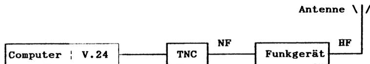
Benötigt wird ein Computer mit V.24-Schnittstelle, ein TNC (Terminal Node Controller), ein Funkgerät für das 70 cm-Band sowie eine Antenne.
