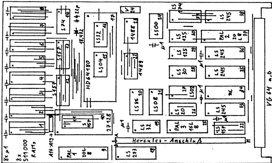
Abb.3: Bestückung- und Dratbrückenplan, Teil-Layout
