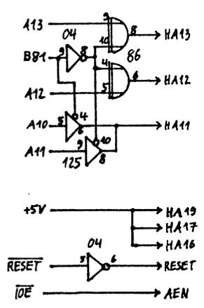
Abb. 1: Bank-Switching Adressdecoder Hercules-Interface
