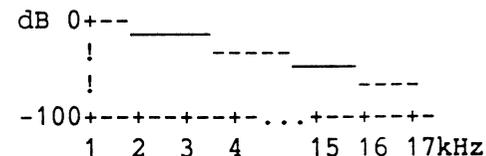
Nur wenig steile Kennlinie => erfordert starken Kompromiß zwischen möglichst geringer Dämpfung der gebrauchten Frequenzen und hoher Dämpfung der 16 kHz
