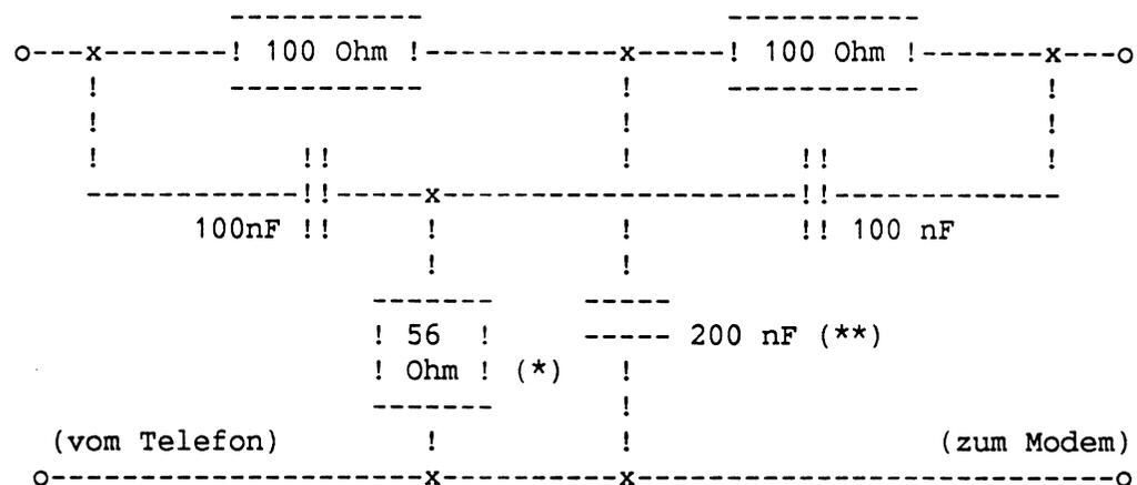
(\*): Rechnerisch 50 Ohm, 56 funktioniert bei mir prima
