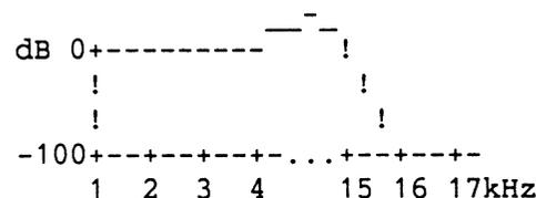
Fast keine Dämpfung im Übertragungsbereich, sehr hohe Dämpfung bei 16 kHz, keine Beeinflussung des Phasenganges im uns interessierenden Übertragungsbereich. Bei 16kHz dann gewaltig, juckt uns aber nicht mehr
