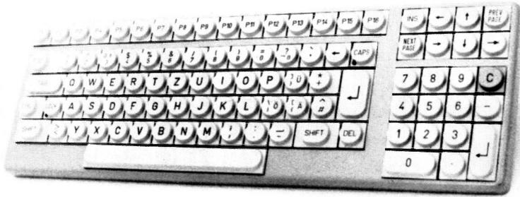
Schreibmaschinentastatur mit seriellem und parallelem Ausgang, durch eigenen Prozessor sehr kompakt aufgebaut: 122 x 392 x 22mm. Das zugehörige Kunststoffgehäuse mißt nur 129 x 400mm. Die Abstände von der Tischplatte zur Tastenmitte in ungedrücktem Zustand betragen: für die Leertaste 25mm. für die Tastenreihe asdf (Mitte) 30mm. für die Zahlenreihe 36mm und für die Funktionstasten 40mm. Damit entspricht die Tastatur dem aktuellen Erkenntnisstand für ermüdungsfreie Arbeit.
