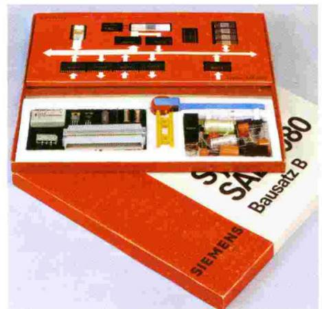
△ Mikrocomputer-Entwicklungsbausatz der Systemfamilie SAB 4080. Er enthält alle für den Aufbau eines Mikrocomputer-Prototyps notwendigen Bauelemente einschließlich Platine, Eingabe-/Ausgabe-Bausteinen und Speicherbausteinen mit 4096 x 4 Bit RAM und 1024 x 8 Bit PROM. Damit lassen sich vielseitige industrielle Steuerungen realisieren.
