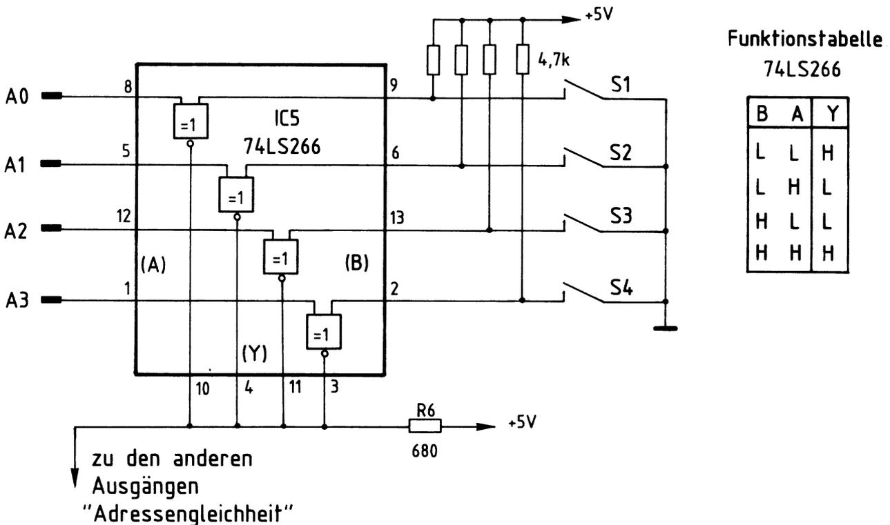
Bild 6: Adressenvergleichler für 4 Adreßleitungen und Funktionstabelle 74LS266
