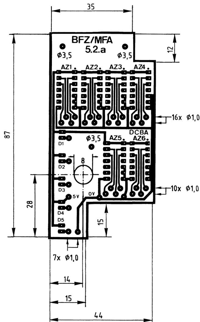
Alle nicht bemaßten Bohrungen  $\phi 0,8$  mm
