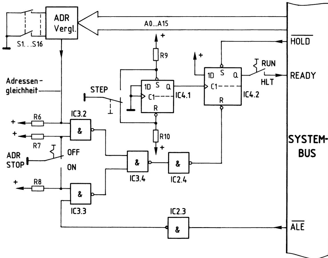
Bild 7: Stromlaufplan für Adressenstop und Einzelschritt- Steuerung
