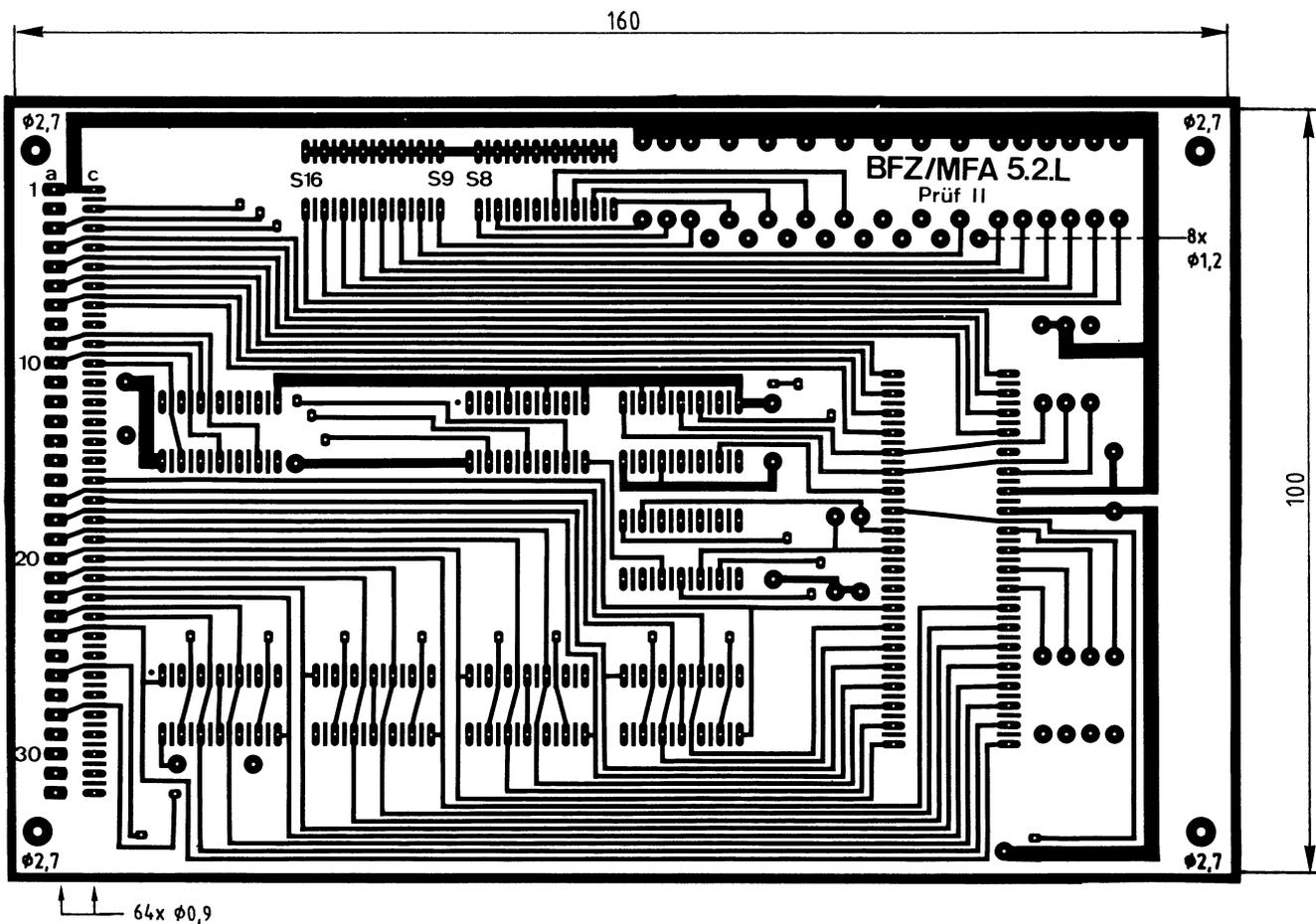
Alle nicht bemaßten Bohrungen  $\phi 0,8$  mm
