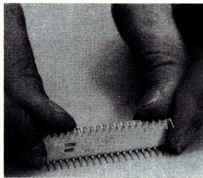
Bild 8: Mit sanftem Druck gegen eine ebene Fläche lassen sich die IC-Beinchen rechtwinklig biegen.
