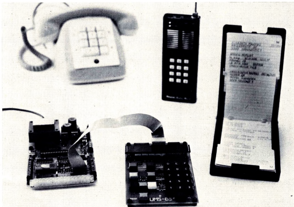
Bild 1: Der Einsatz als Rufnummerngeber bereitet einem Mikrocomputer keinerlei Schwierigkeiten.
