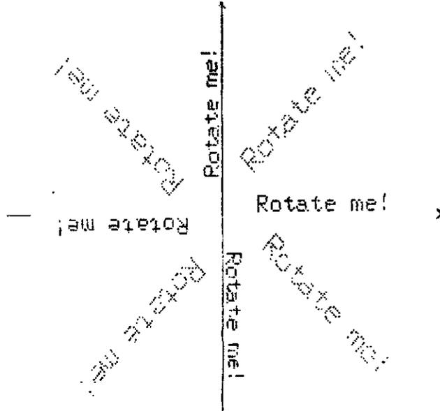
Beispiel für die 8 Textrichtungen von 0 bis 315 Grad in 45 Grad Schritten.
