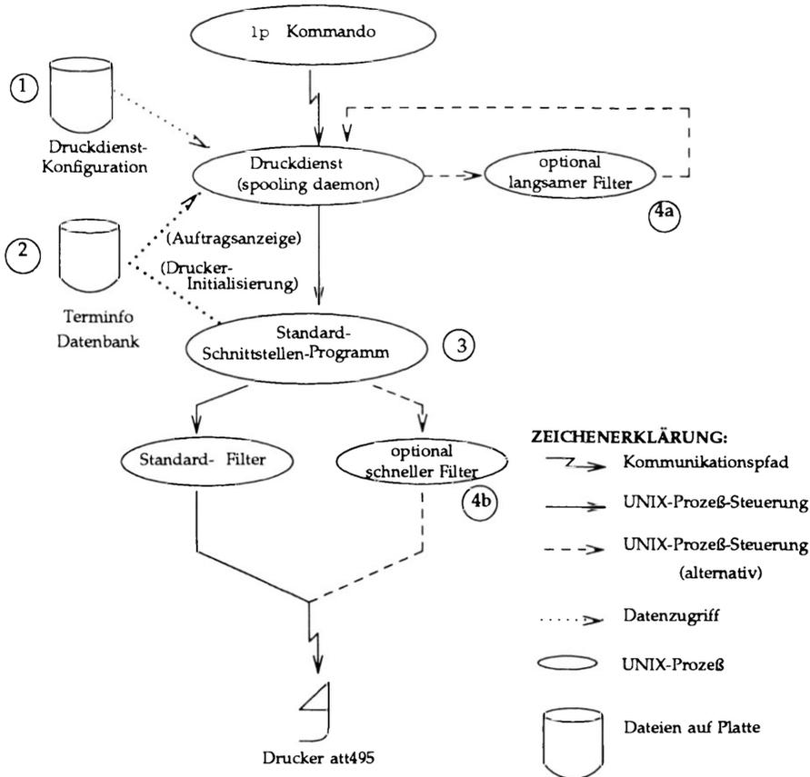
Jeder Druckauftrag wird an einen *spooling daemon* gesendet, der alle Druckaufträge verfolgt. Der Dämon-Prozeß wird erzeugt, wenn Sie den LP-Druckdienst starten. Dieser UNIX-Systemprozeß ist auch für das Verfolgen der Zustände der Drucker und langsamen Filter verantwortlich. Beendet ein Drucker die Ausgabe der Datei eines Benutzers, veranlaßt ihn der Dämon, noch einen Auftrag zu drucken, falls sich einer in der Warteschlange befindet.
