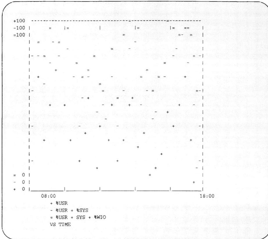
In diesem Bild ist der Prozessor über drei Zeitintervalle vollständig ausgelastet: 9–10 Uhr, 13–14 Uhr und 15.30–17.30 Uhr. Beachten Sie, daß der tatsächliche Zeitanteil, über den der Prozessor belastet ist, die Summe der Zeit im Benutzermodus (%usr) und der Zeit im Systemmodus (%sys) ist. Wenn sich diese Summe den 100% annähert, dann arbeitet der Prozessor mit seiner maximalen Kapazität. Die Summe von %usr + %sys + %wio ist ungefähr dasselbe wie die Summe von %usr + %sys (%wio ist niedrig).
