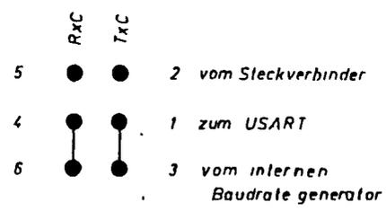
Lötbrücken zur Verbindung des USART mit dem Empfangs- bzw. Sendetakt vom Steckverbinder zum USART vom internen Baudrate generator
