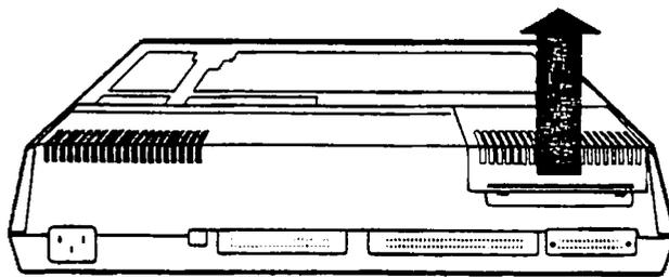
Steckmodul: Die Abdeckkappe wird in Pfeilrichtung abgezogen.
