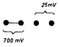
Rangierverbinder zur Einstellung der Ausgangsspannung an PIN 1 und 4 der Cassettenrecorderschnittstelle
