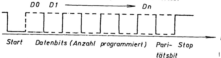
Bei synchroner Datenübertragung entfallen Start- und Stoppbits.
